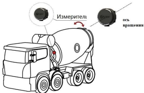
Рис.2 Размещение DU-BLE на бетономесителе в режиме горизонтального вращения.
