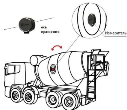
Рис.1 Размещение DU-BLE на бетономесителе в режиме вертикального вращения.
